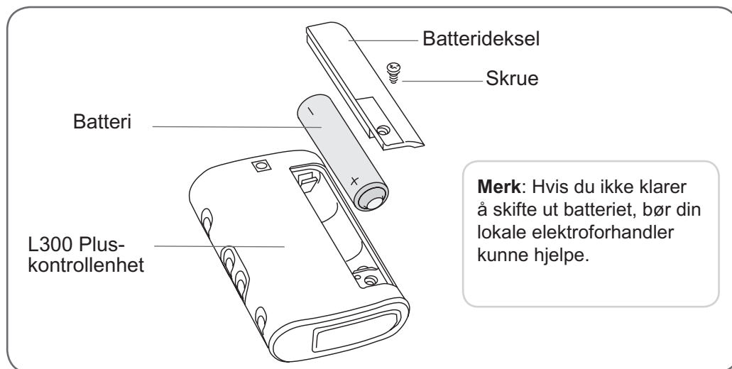
Figur 9-5: Bytte L300 Plus-kontrollenhetens batteri
